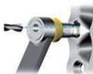
Barrenado e implante del tornillo con vaina protectora de partes blandas
